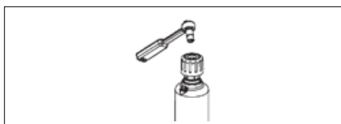
Рис. 11. Настройка перепада давления производится стандартными ключами
